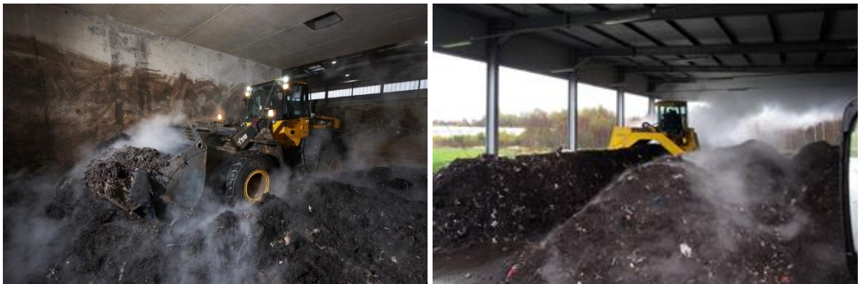
Abbildung 7: links: Befüllung der Konditionierungsboxen, rechts: Umsetzen einer Nachrottemiete
